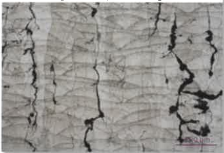
Alliage 7020 attaqué - cordon et grains
