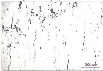
Alliage 7020 attaqué - cordon et grains
